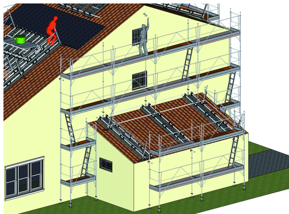
Réalisation d'échafaudage sur pignon à partir de toit à une pente
