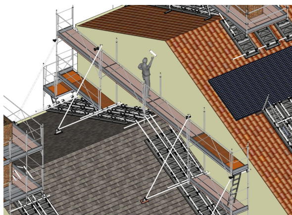
Réalisation d'échafaudage sur pignon à partir de toit à deux pentes
