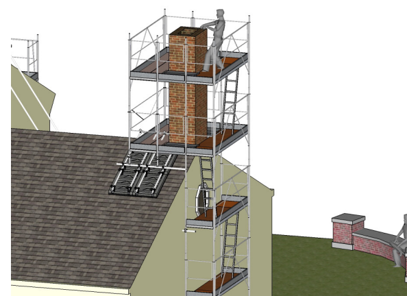
Réalisation de cheminée en bout de pignon
