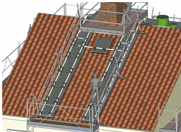
Réalisation de cheminée sur faîtage
